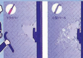
▲網入板ガラス 一見頑丈そうな網入板ガラスも簡単に割れてしまいます。
